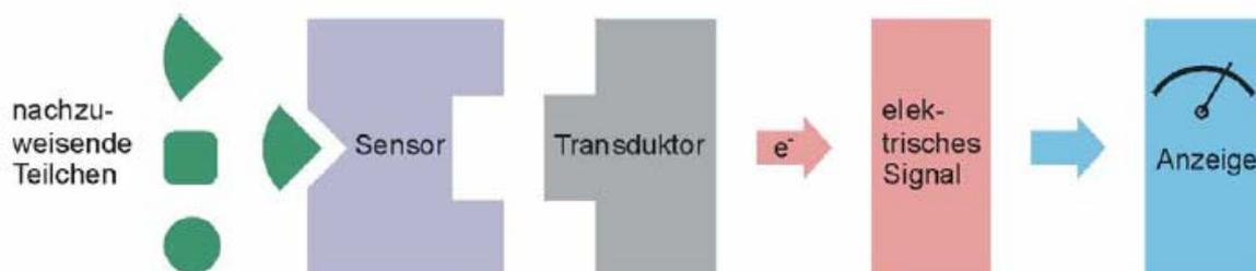
Abbildung 5-12: Funktionsweise eines chemischen Sensorsystems [108].
