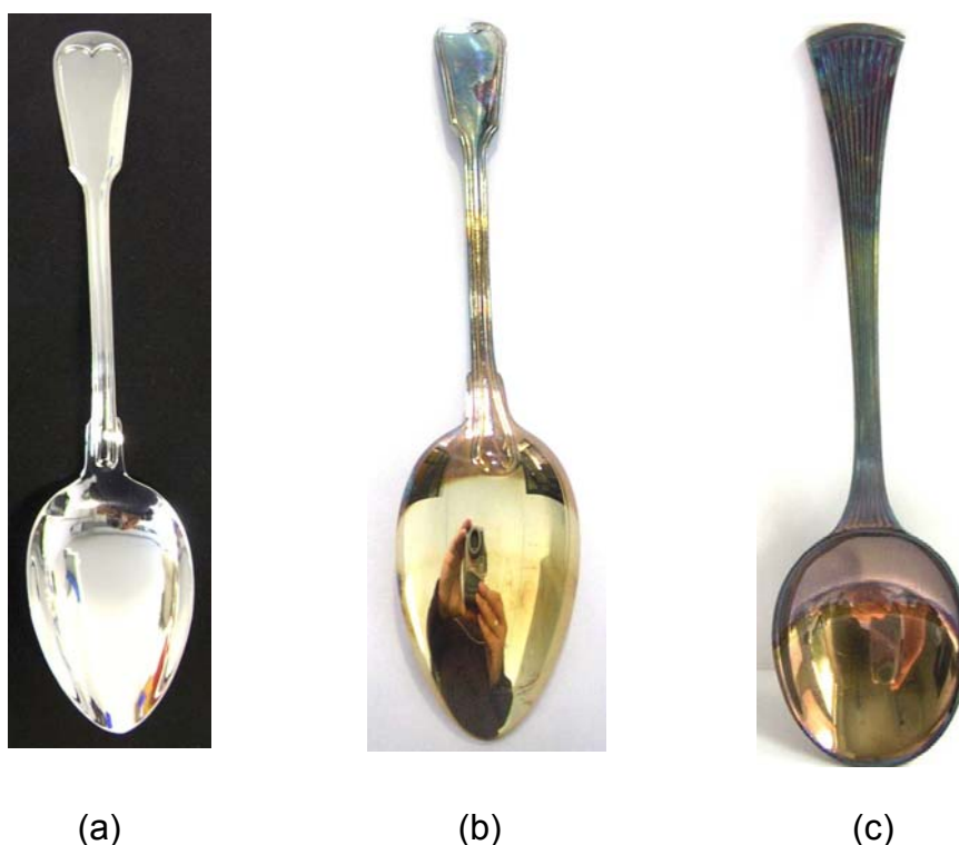
Abb. 5.20: Ultradünner HTSHP-CMC Korrosionsschutz an Silberlöffel:
