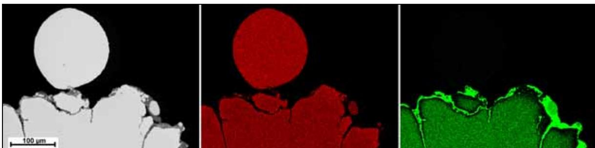
**Bild 4.24:** EDX-Mapping an einem Querschliff einer Elektrode aus einer PtNi10-Legierung: REM-Aufnahme (links), Platin-Verteilung (Mitte), Nickel-Verteilung (rechts). Während die Elektrode sowohl Platin als auch Nickel enthält, besteht die Kugel fast ausschließlich aus Platin.
