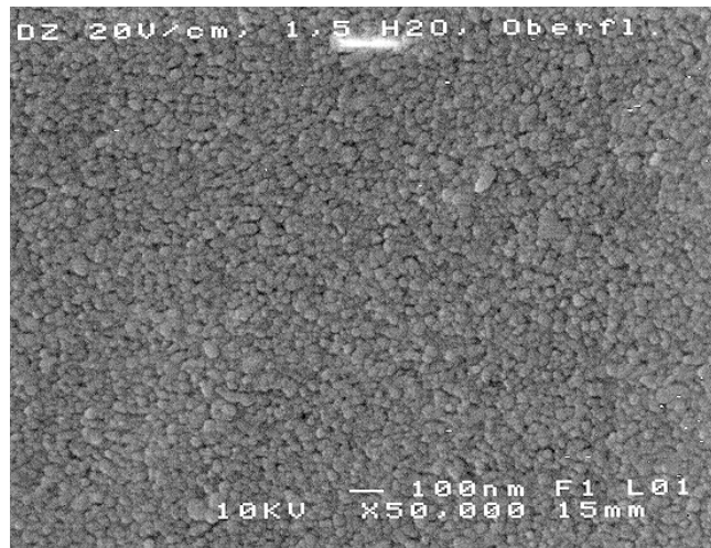
Bild 75: HREM-Aufnahme der Oberfläche eines Grünkörpers, der aus einer ethanolischen Suspension folgender Zusammensetzung: 40 Gew.-% Degussa ZrO_2 ; 4,2 Gew.-% Trioxadecansäure; 1,5 Gew.-% Wasser; elektrophoretisch abgeschieden wurde. Die Abscheidefeldstärke war 20 V/cm bei einer Abscheidendauer von 30 Minuten.
