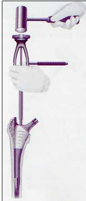
Abb. 11 Einschlagen des Implantates mittels eines Schafteinsetzers (aus Operationsanleitung Anatomischer Femurschaft Image HA, Fa. Smith & Nephew Orthopaedics GmbH, Tuttlingen, Deutschland)
