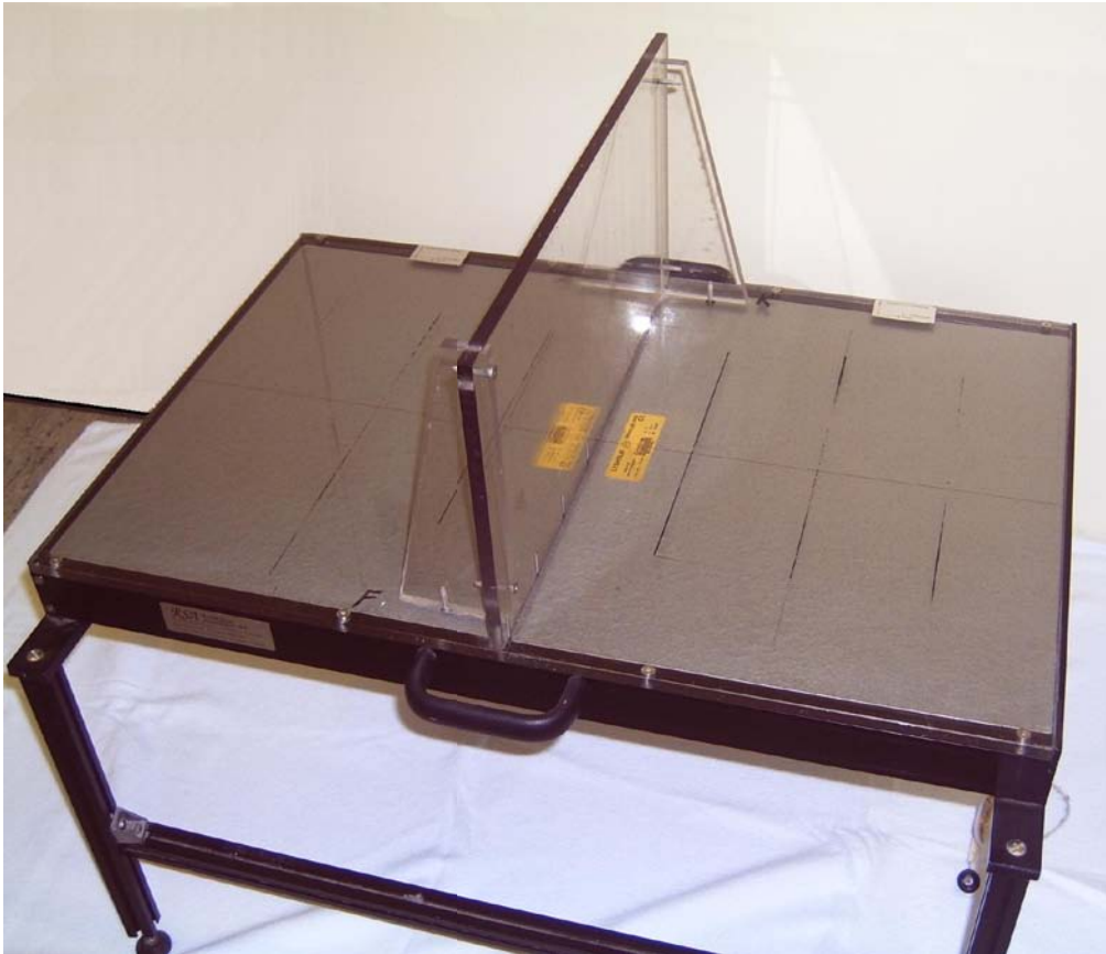
Abb. 16 uniplanarer RSA- Kalibrierungskäfig Nummer 41 der Firma RSA Biomedical Innovations AB, Umeå, Schweden
