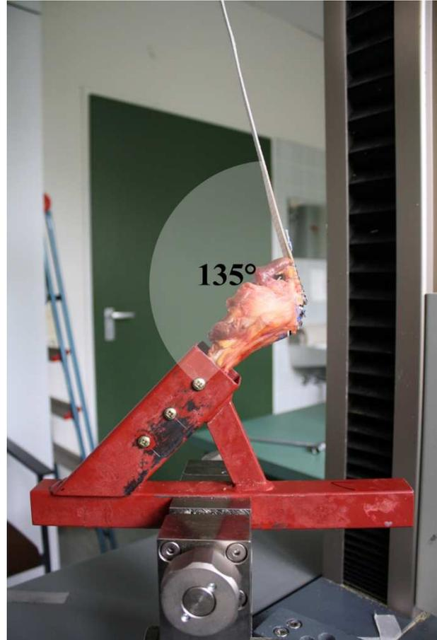
Abbildung 18: Montage des Präparats in der Materialprüfmaschine. Die Halterungsvorrichtung mitsamt Präparat ist im feststehenden Bereich der Maschine, das hochvernetzte Kunststoffband im Bereich der beweglichen Traverse, fixiert.
