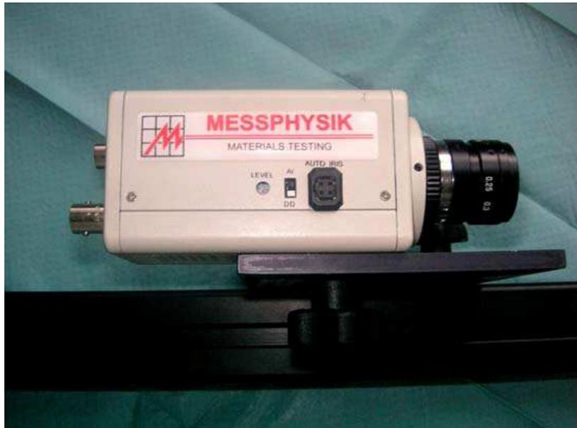
Abbildung 16: Videoextensometer der Firma Messphysik. Nach vorhergehender Kalibrierung und Ausrichtung misst es den Abstand der zwei am Präparat angebrachten Messstreifen. Gleichzeitig wird das Präparat einer zyklischen Belastung durch die Materialprüfmaschine unterzogen.
