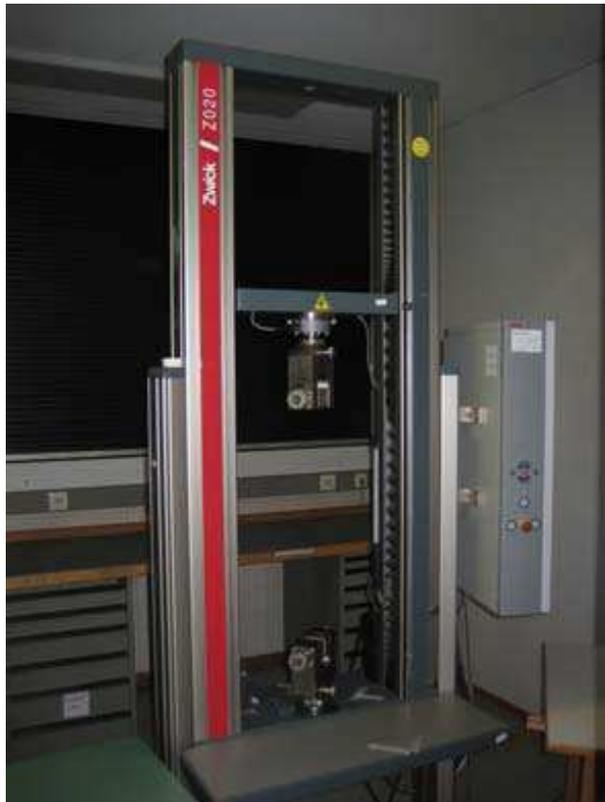
Abbildung 15: Universalmaterialprüfmaschine der Firma Zwick.
