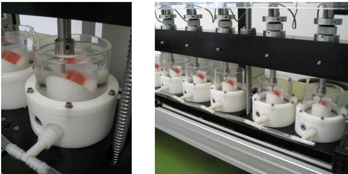
Abb. 41: Kausimulator: links geflutete Einzelkammer mit einer eingespannten Probe, rechts Gesamtanordnung (aus (152)).
