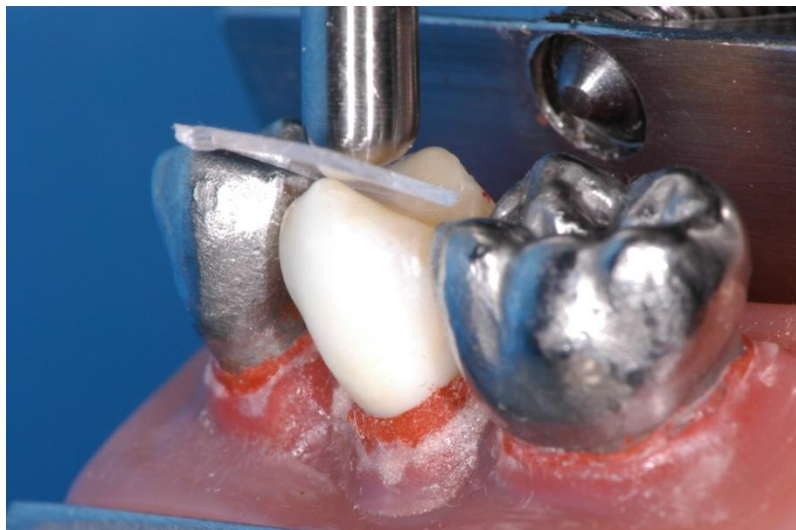
Abb. 45: Prämolare mit mesialer und distaler Nachbarzahn und mit Kompositfüllung in Universalprüfmaschine mit Thermoplastfolie eingespannt.
