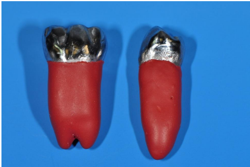
Abb. 11: Molaren- und Prämolarenanalog mit simuliertem Parodontium (Anti-Rutsch-Lack).
