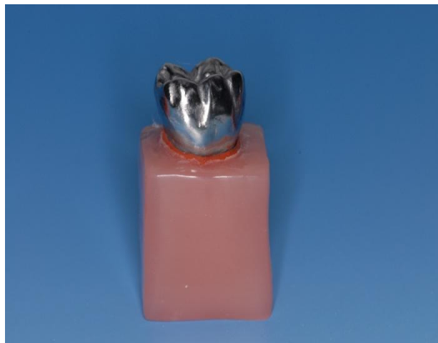
Abb. 12: Fertiger Protokörper für die Ermittlung des Resilienzverhaltens der Molarenanaloge.
