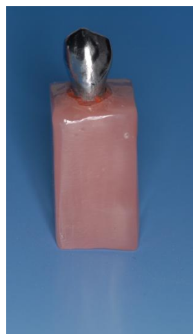
Abb. 13: Fertiger Protokörper für die Ermittlung des Resilienzverhaltens der Prämolarenanaloge.
