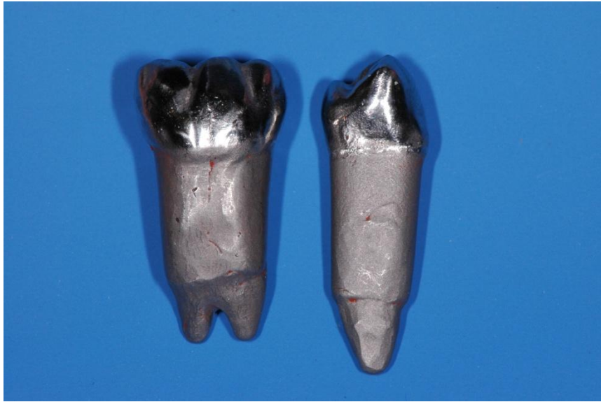
Abb. 5: Molaren- und Prämolarenanalog aus einer Co-Cr-Mo-Legierung.
