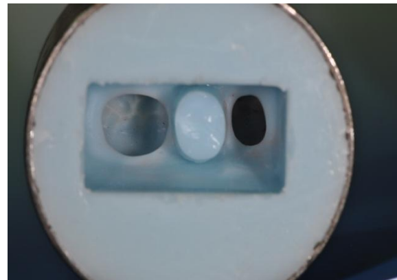
Abb. 22: Dublierform zur Herstellung d. Protokörper „Prämolar mit zwei Approximalkontakten“.
