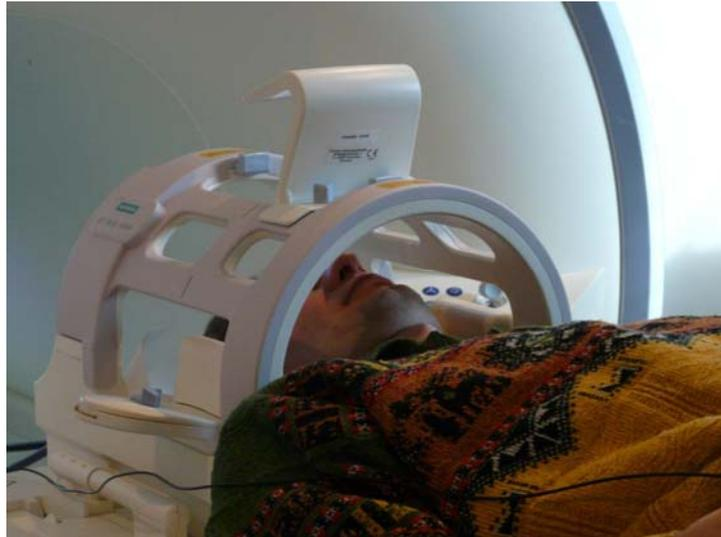
**Abbildung 25: Kopfspule mit aufgesetztem Spiegel.**
