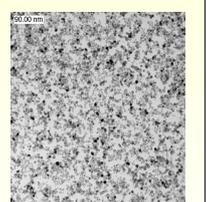
Abb. 9: TEM: Nanopartikuläres ZrO<sub>2</sub>, Referenzmaterial.
