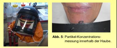
Abb. 4: Atemschutzhaube mit Frischluftzufuhr. Abb. 5: Partikel-Konzentrationsmessung innerhalb der Haube.
