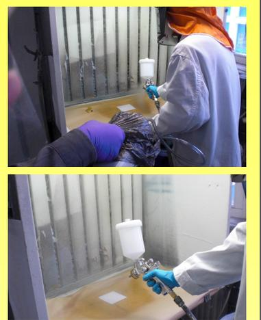
Abb. 2 und 3: Spritzlackieren mit nanopartikulären Lacken.
