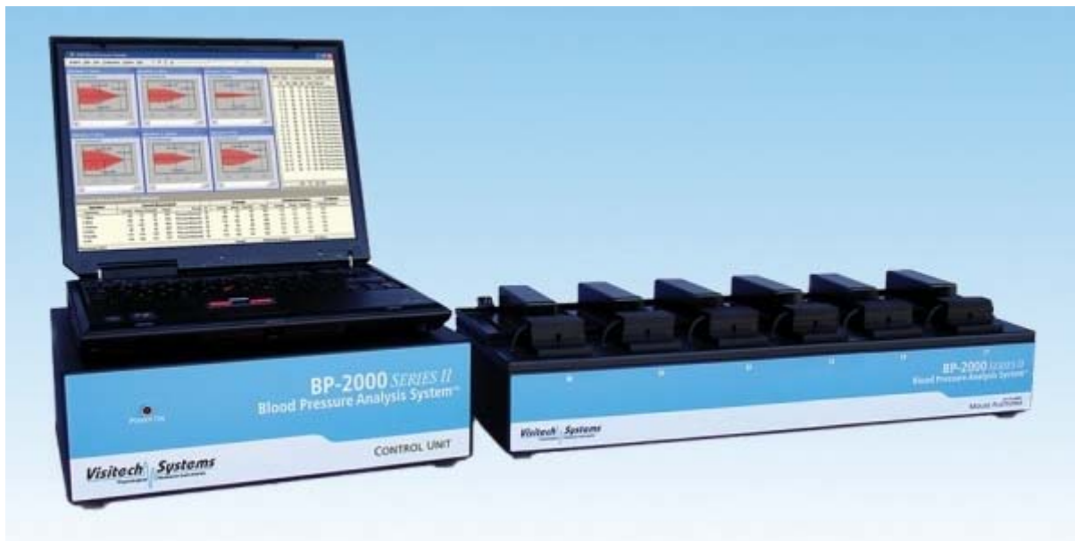
Abbildung 3: Messstation zur nicht-invasiven Blutdruck- und Herzfrequenzbestimmung bei Mäusen (BP-2000 series II, Abb. aus www.visitachsystems.com )
