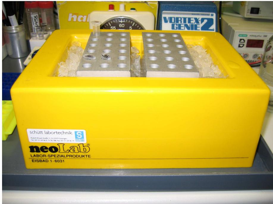
Abb. 21: Eisbad zur Kühlung der Proben
