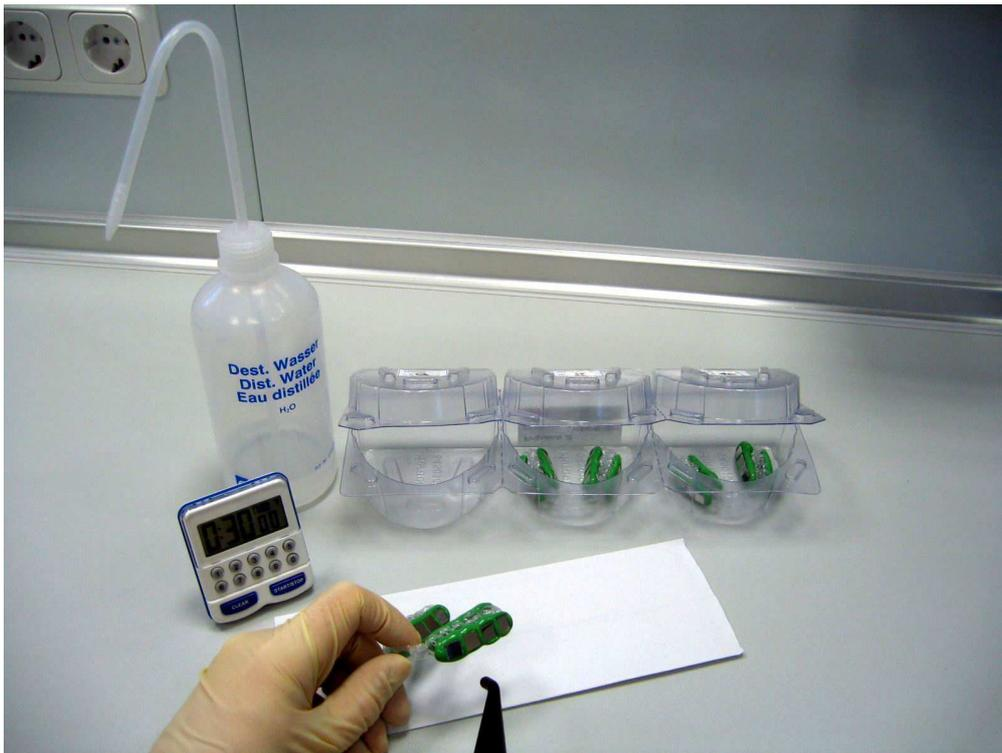
Abb. 9: Schienenentnahme, Spülung und Lufttrocknung der Prüfkörper
