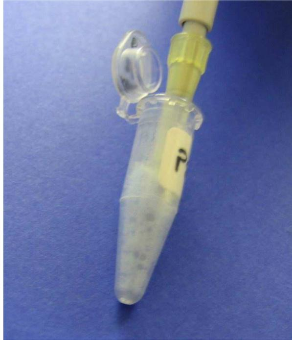
Abb. 14: Vermischen der Pellets mit Lämmli-Puffer
