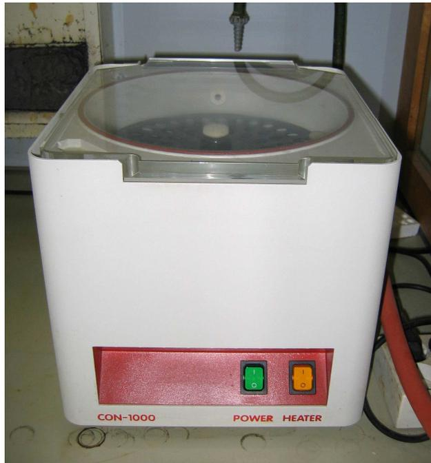
Abb. 23: Vakuumzentrifuge Con-1000
