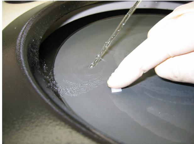
Abb. 4: Polieren der Prüfkörper mit Nassschleifpapier
