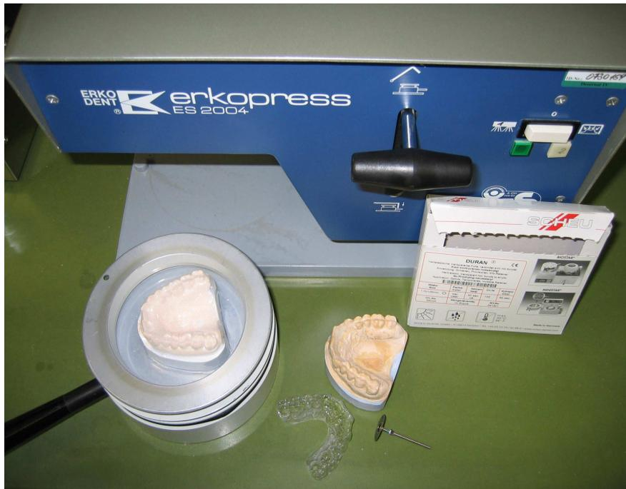
Abb. 3: Tiefziehapparatur und Materialien zur Herstellung der Trageschienen
