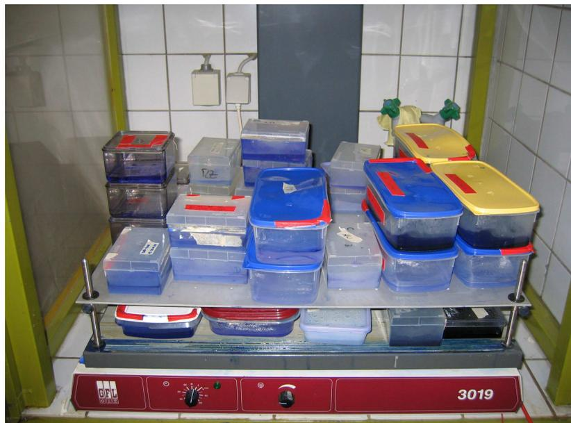
Abb. 32: GFL Schüttelapparat mit den Gelen in Färbelösung
