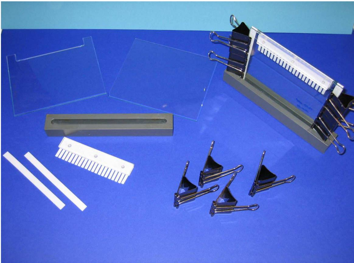
Abb. 24: Formteile für den Guss der High-Tris-Gele
