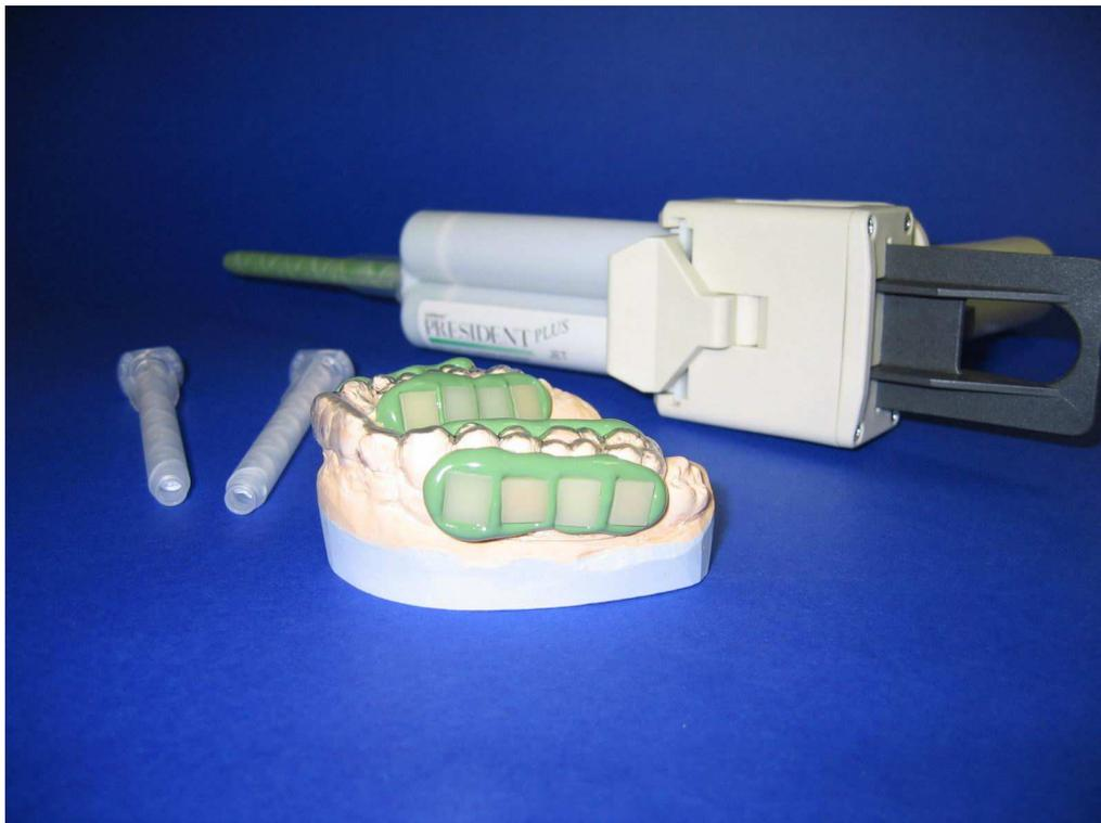
Abb. 8: Trageschiene mit montierten Keramikprüfkörpern auf Modell und Silikonpistole
