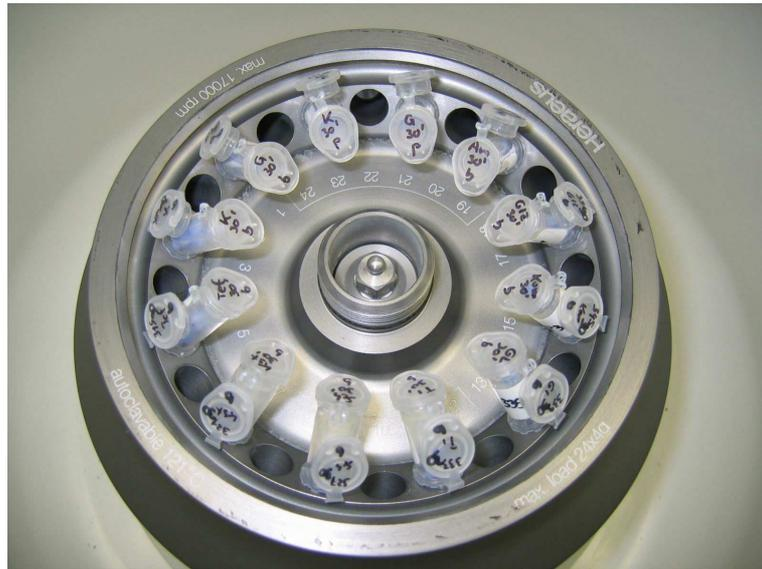
Abb. 17: bestückter Zentrifugenrotor
