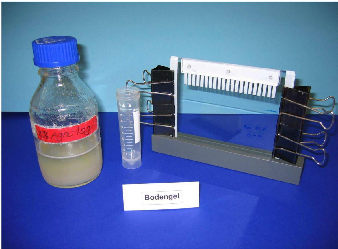
Abb. 25: Materialien zum Guss des Bodengels
