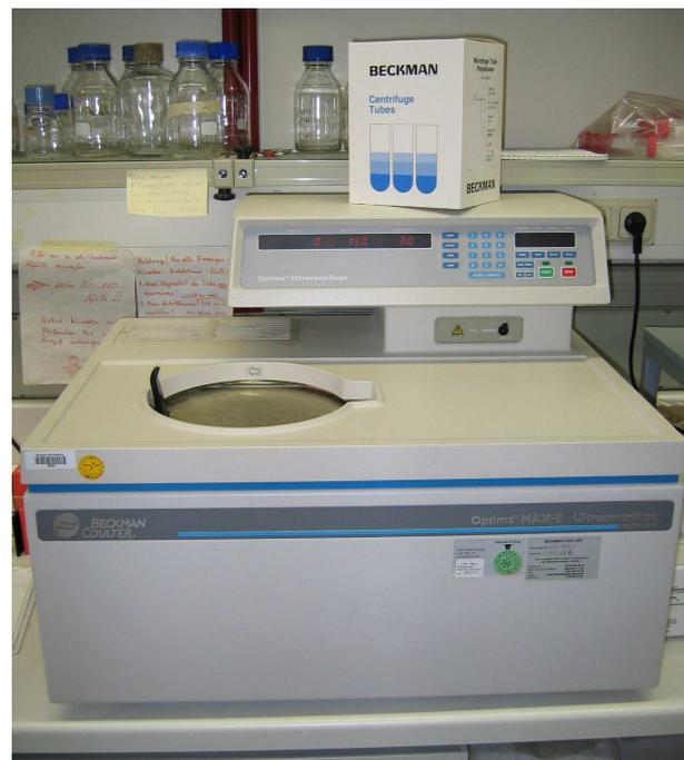
Abb. 20: Ultrazentrifuge Beckmann Coulter Optima™ Max-E
