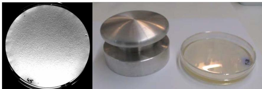
Abbildung 12: Fotografien eines bewachsenen Filters (links) und des verwendeten Metallstempels (rechts)
