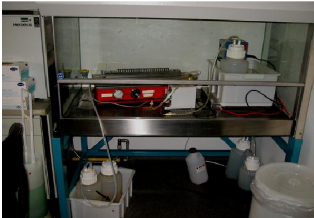
Abbildung 4 Übersicht des Versuchsaufbaus: Der Pfeil markiert den Abfluß über einen Silikonschlauch in eine Polypropylenflasche, die als Abfallbehältnis dient.
